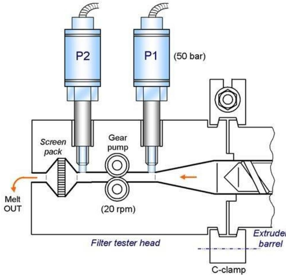
Тест определяет «негабаритные» частицы в образце
